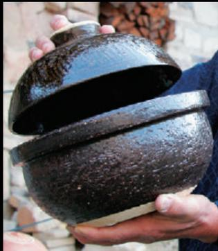
炭化物がたくさん含まれている。この土を焼くと、その炭化物が燃え尽きて、小さな空洞「気孔」となるのだ。こうした「多孔質の粘土」で作られた伊賀焼には、空気がたくさん含まれているため、火に強く、冷めにくく、そして水をよく吸収するという、優れた性質を持つているのである。
